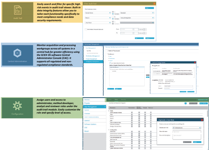
图4. SCIEX OS 软件上用于监控用户访问和评估审计跟踪的功能。审计跟踪视图允许用户轻松过滤高风险事件，并启用数据完整性功能以满足合规性要求。该软件具The Central Administrator Console（CAC）可集中监控所有系统的采集和处理。CAC 功能支持受监管和不受监管的合规性标准。配置模块使用户能够轻松设置管理员、方法开发人员、分析人员和审阅者角色的角色和访问级别。
