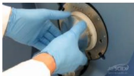
図.カーテンプレートの取り付け
