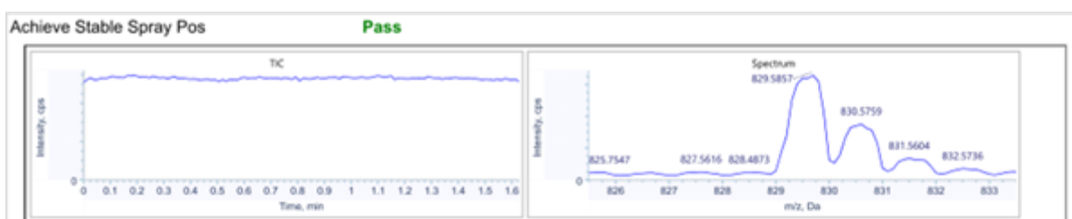
Illustration 5-14 : Exemple : spray stable (polarité positive, mode Low Mass)
