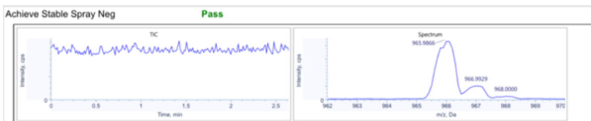
Figura 5-15: Ejemplo: Pulverización estable (polaridad negativa, modo de masa alta)
