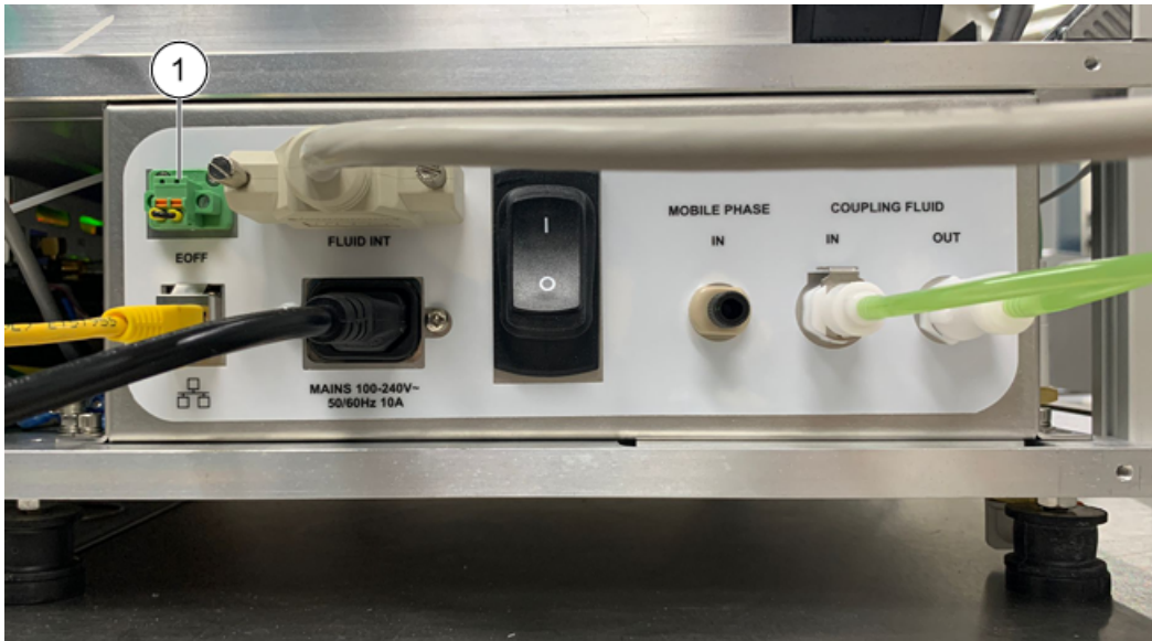
Figura 6-3 Conector e plugue de desligamento de emergência no painel traseiro do módulo Echo ® MS
