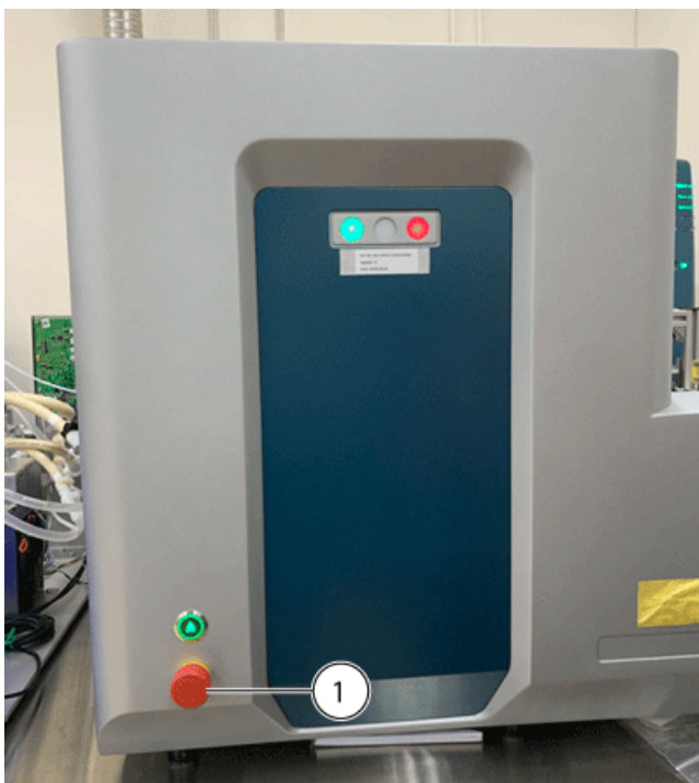
Figura 6-2 Botão de desligamento de emergência no painel frontal do módulo Echo® MS
