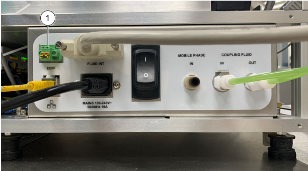
그림 6-3 Echo ® MS 모듈 후면 패널의 비상 차단 커넥터와 플러그
