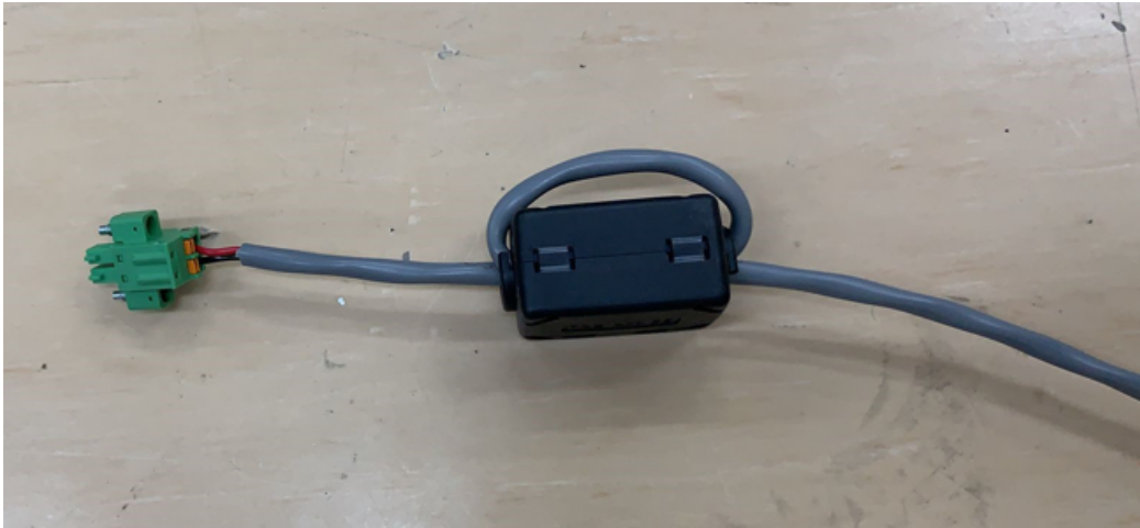
그림 6-1 차폐 케이블 또는 페라이트 코어가 있는 비차폐 케이블
