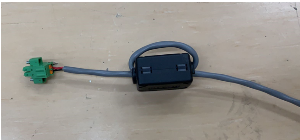
図 6-1 シールドケーブルまたはフェライトコアを付加した非シールドケーブル
