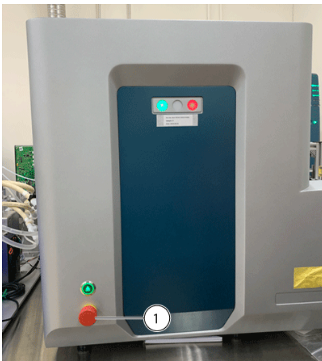
Figura 6-2 Pulsante di arresto di emergenza sul pannello anteriore del modulo Echo ® MS
