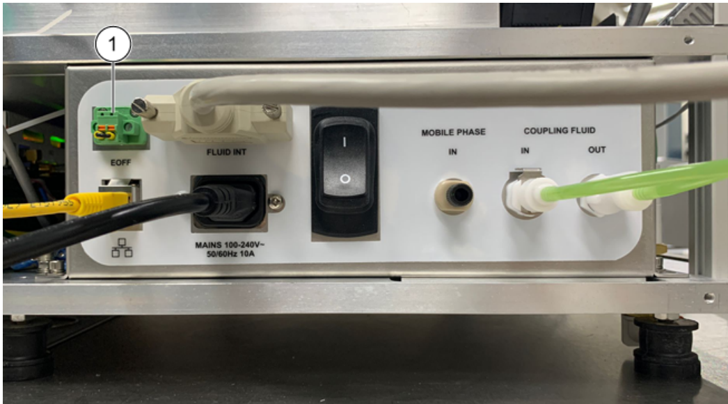
Figura 6-3 Presa e connettore di arresto di emergenza sul pannello posteriore del modulo Echo ® MS
