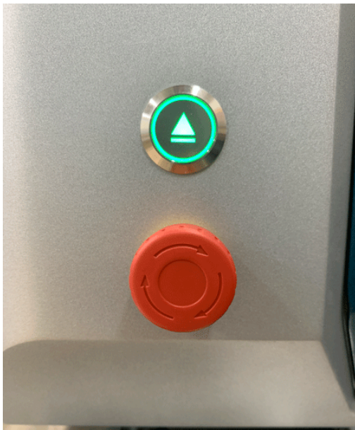
Figure 6-5 Tournez le bouton d'arrêt d'urgence dans le sens des aiguilles d'une montre
