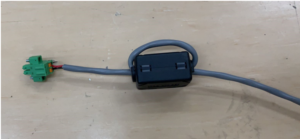
Figure 6-1 Câble blindé ou câble non blindé avec noyau de ferrite ajouté
