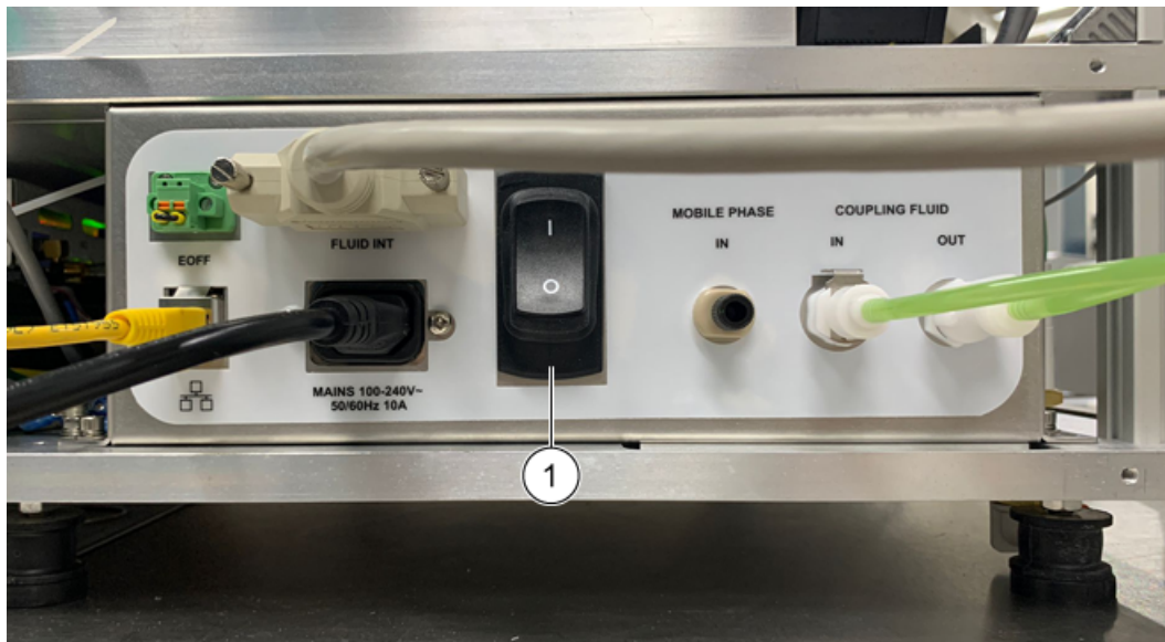
Figure 4-2 Interrupteur du module Echo® MS
