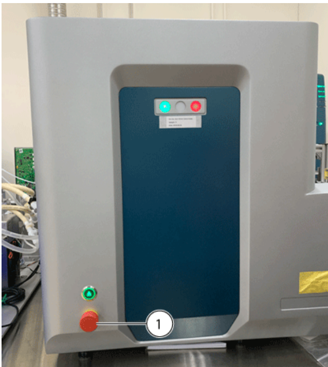
Figure 6-2 Le bouton d'arrêt d'urgence sur le panneau avant du module Echo® MS
