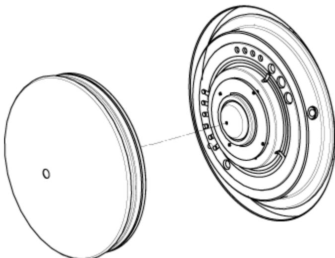
气帘板通过安装在锥孔板上的三个定位球掣而保持在适当的位置。
