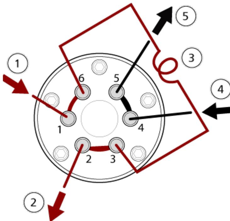
图 3-6 分流阀 - 进样模式 B 位
