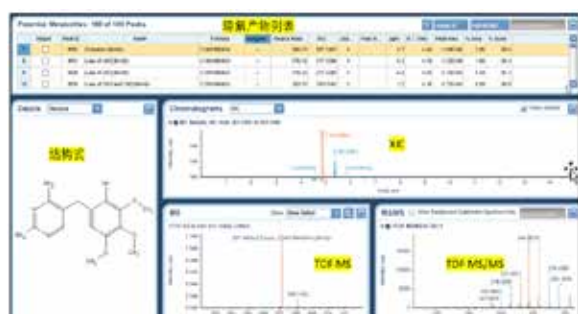
图4. MetabolitePilot™软件自动完成数据分析，给出降解产物的提取离子流图、高分辨率的一级和二级质谱信息、结构式等信息。
